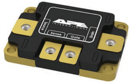
图1 新型 Wolfspeed 功率器件模组。整个器件略大于 25 美分硬币。
