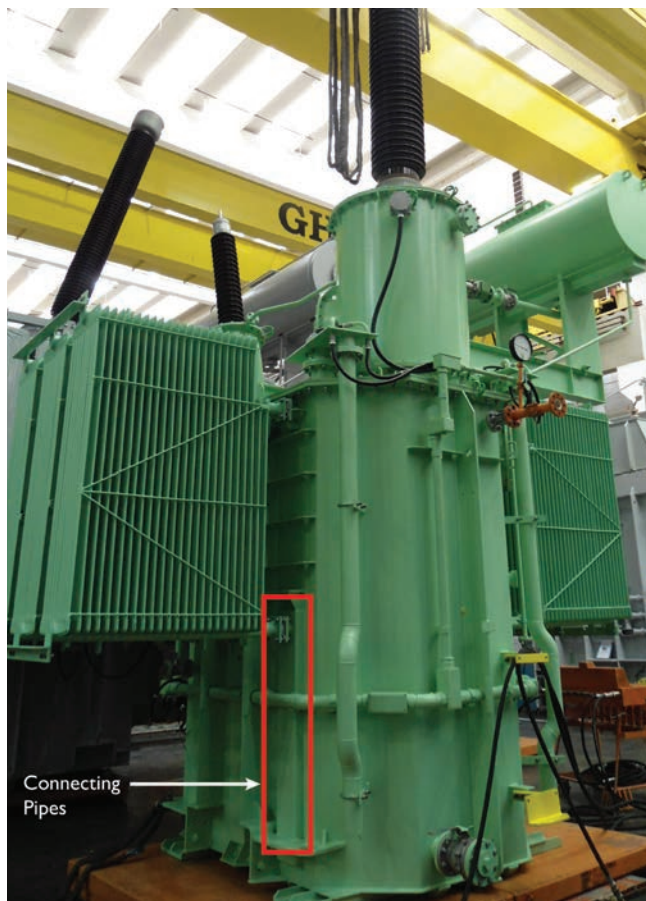
图 1 并联电抗器。电抗器外焊接着矩形盒子, 盒内有管道与电抗器箱体相连接, 在最初的油路设计中, 散热器通过这些管道与电抗器箱体相连接。图注: Connecting Pipes - 连接管。
