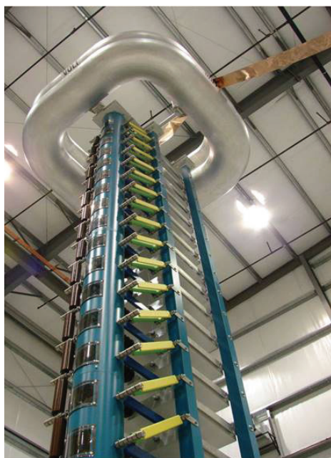
图 1 NTS 运营的高压发生器 (2.4 兆伏的马克思发生器)。
