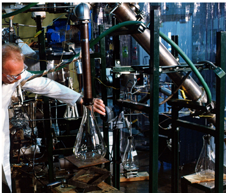
图 1. 准备热解时, 如左图所示的木质生物质被粉碎, 并可能经过其他化学处理。要开发一个完整的热解模型 (右图), 需考虑多个物理过程, 包括传热、传质、化学反应和相变。照片中的长颈烧瓶会收集在试运行反应器中经热解产生的浓缩生物油蒸汽。图片提供者: Warren Gretz (NREL 05756, 左) 及 Phil Shepherd (NREL 03677, 右)。
