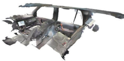
图 3. 哈曼公司提供的车厢三维扫描图。
