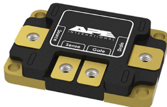
新型 Wolfspeed 功率器件模组。整个器件略大于 25 美分硬币。
